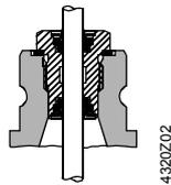
Замена кольцеобразного сальника EPDM-O, включая плоский уплотнитель из меди, для охлажденной воды, горячей воды низкой температуры и рас-сола – 25 ... + 130 °С
