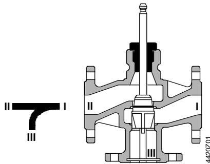
В зависимости от номинального размера, используется регулирующий перфорированный или пазовый плунжер, непосредственно соединенный со штоком клапана DN15...50 с закрытым байпасом с приводом SQX используется. Седло запрессовано в корпус клапана
