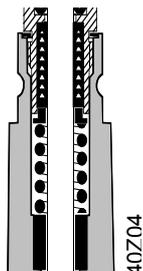
Замена сальников PTFE, включая плоский из меди, для горячей воды повышенной температуры, насыщенных паров, горячего пара и термических масел 130... 180 °С
